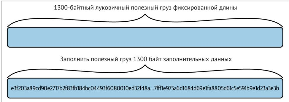
Рис. 10-16. Заполнение полезного груза луковицы потоком случайных байтов
