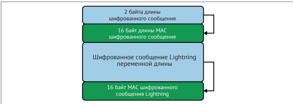
Рис. 14-2. Структура шифрованного пакета
